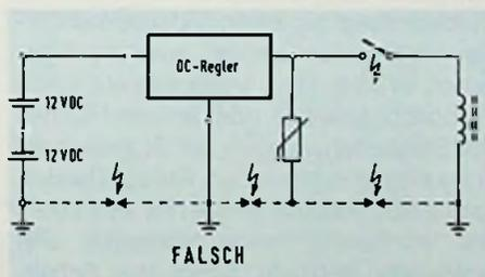
Bild 1: Störspannungsschleifen bei unsachgemäßer Verdrahtung des DC-Reglers
