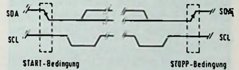
**Bild 3: Takte auf Datenleitung (oben) und Taktleitung, beim I<sup>2</sup>C-Bus**
