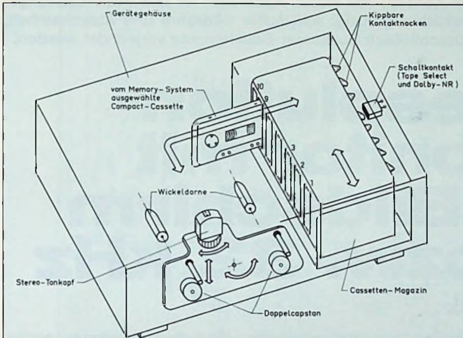
Bild 2. Konstruktiver Aufbau und Funktionsweise des Cassettenwechslers
