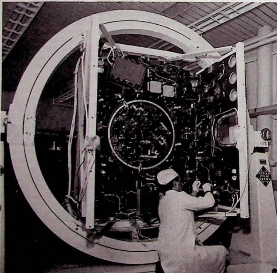
**Bild 2:** Nachrichten-System des dritten europäischen Fernmelde-Satelliten ECS-F3 bei der Montage in Backnang (ANT-Pressbild)
