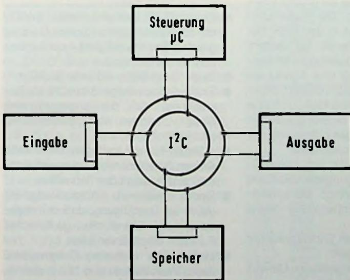
**Bild 1: Digitales System mit seriellen Bus**
