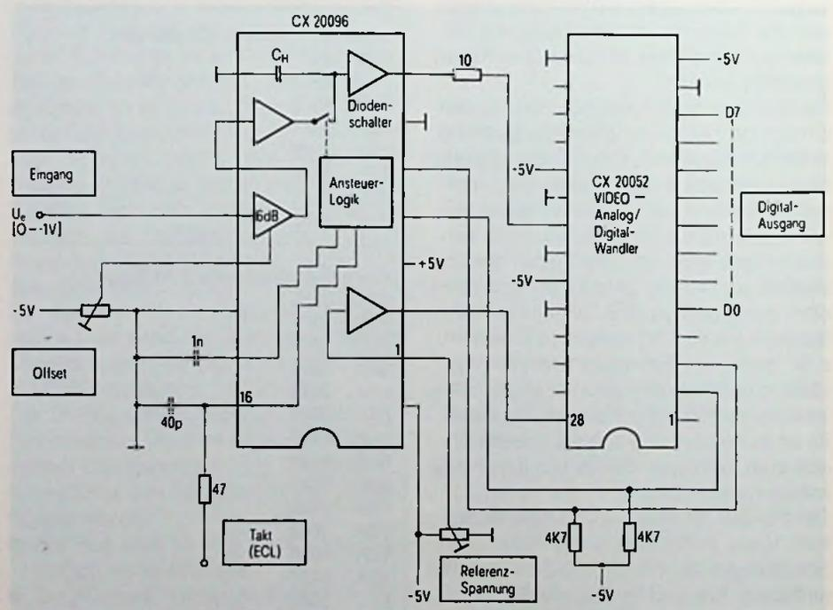
Bild 1: Äußere Beschaltung der Sample-and-Hold-Schaltung
